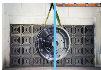
Nieuwe lakinstallatie met afzuigkast en filtersysteem voor een aanzienlijke reductie van de milieubelasting
