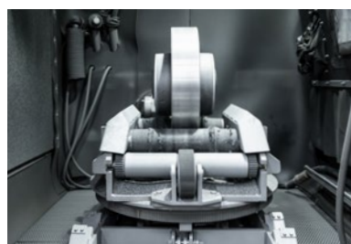
Speciaal op onze producten afgestemde zandstraalinstallatie
