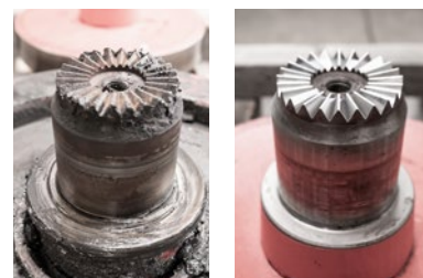
Voorbeeld van een reparatie van een tandwieloverbrenging
